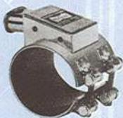
Ensemble de chauffe en inox. Serrage par brides et vis BTR sur double enveloppe. Tension 230V ou 400V monophasé. Triphasé sur demande.
